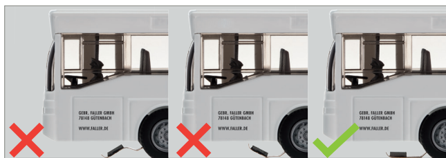
Abb. 3: Einstellung des Lenkschleifers
